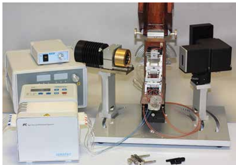
LABORATORNÍ SENZOR založený na spektroskopii povrchových plazmonů.
