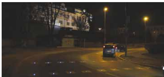
CYKLOPŘEJEZD je osázen výstražnými světly v povrchu silnice.
